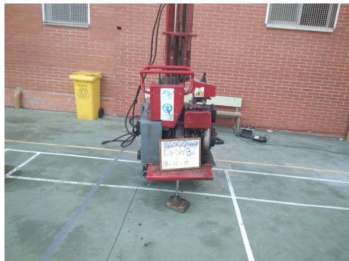
Fotografía 3: Emplazamiento del ensayo de penetración dinámica DPSH nº3 con puntaza perdida
