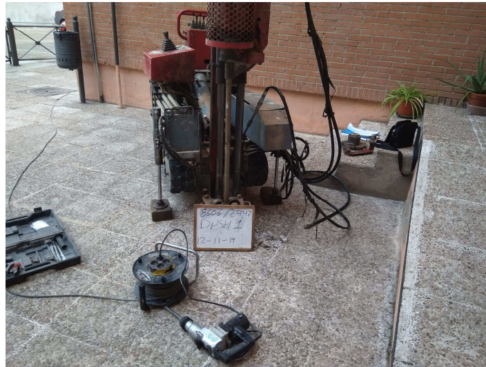
Fotografía 1: Emplazamiento del ensayo de penetración dinámica DPSH nº1 con puntaza perdida
